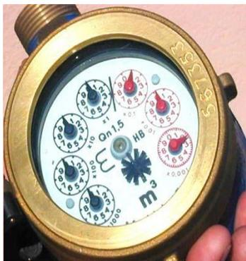
⇒ Le ultime generazioni di **contatori acqua** sono a getto unico e a **lettura diretta**, con strutture più evolute, anti-frode e molto sensibili. Permettono una lettura facile e immediata in tutte le posizioni.
